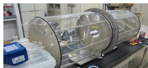
分離式シュミレーションチャンパーによるバイオエアロゾルの耐ストレス実験の様子
