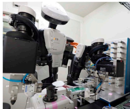
ロボットによるPM 2.5 採取用ろ紙の秤量
