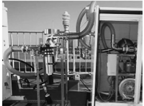
バーチャルインパクターとサイクロンを組み合わせた微小粒子と粗大粒子の大流量同時採取装置 K-ViC (Keio-Virtual Impactor with Cyclone) リアルインパクタータイプ (K-RiC) と合わせて、現在国内外7カ所に設置されています！
