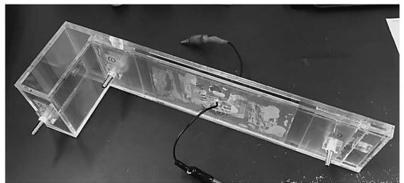
電気移動度法による粒子帯電測定装置 K-MACS (Keio-Measurement System of Aerosol Charging State)
