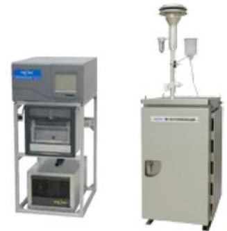
環境大気測定装置 NO x 測定装置(左)、 PM 2.5 測定装置(右)
