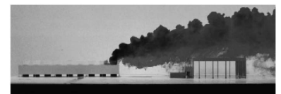
図5 水槽での冷却塔排気の可視化
