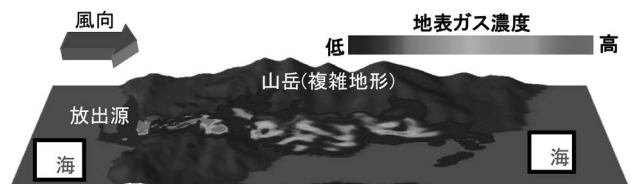
図7 LES計算による複雑地形上での瞬時濃度の様子
