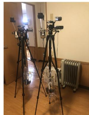
室内空気のサンプリングと換気測定
