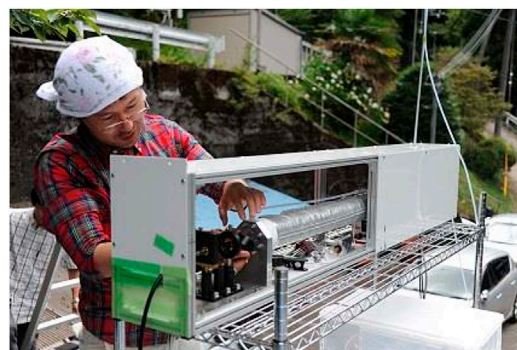
広帯域キャビティ増幅吸収装置(IBCEAS)の調整の様子(調整している人は中嶋)
