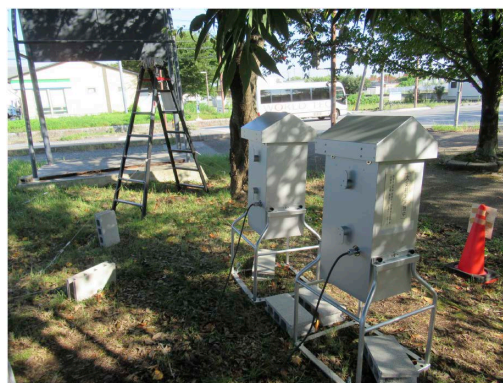
大学前の沿道での大気観測風景。脚立に取り付けた防犯カメラ映像による車両台数の計測（手作業）は、観測後の地獄の試練。
