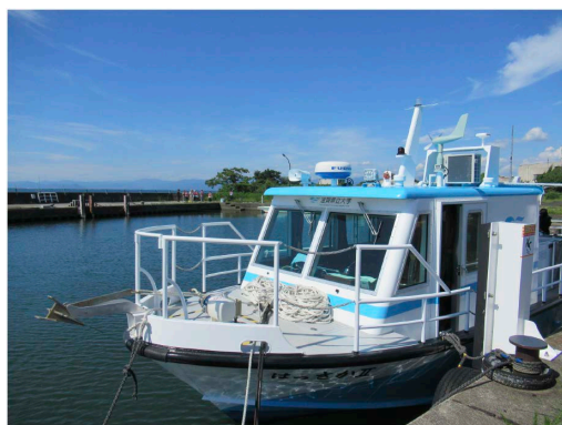
学部附属施設が保有する実習調査船。ディーゼル発電機搭載なので、沖合いで電源も確保できる。
