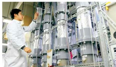
生物脱臭装置の室内試験機
